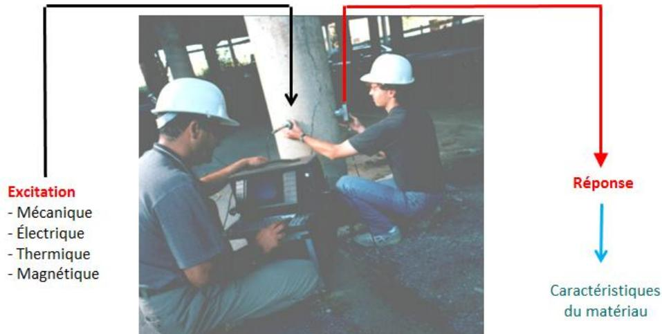
Figure 1 : Principe général des techniques de CND
