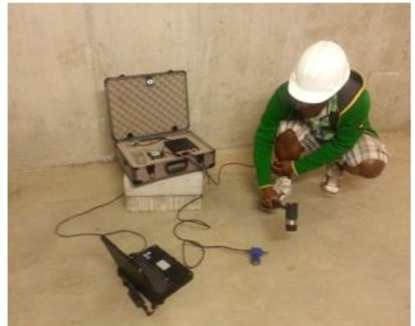
Figure 1: Essai avec la technique de la RI
