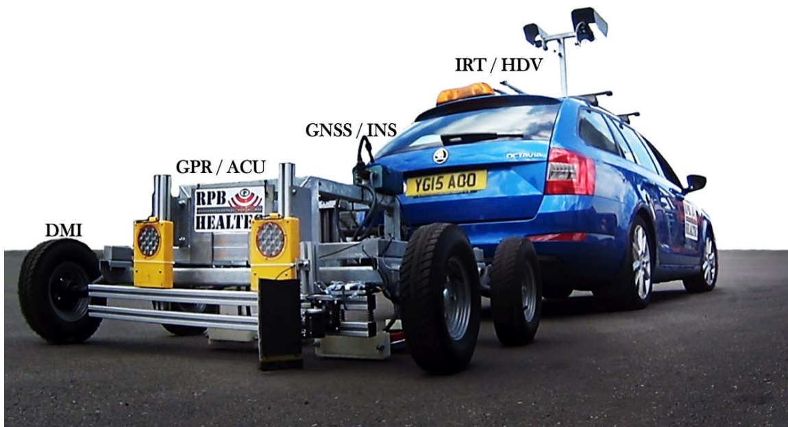
Figure 6 : Système d'auscultation des chaussées intégrant le pulse-echo [Réf. 6]
